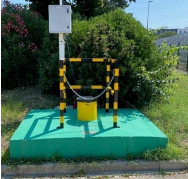
*Figure 7: Exemple de piézomètre du CNPE*
