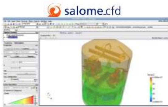
Exemple de posttraitement d'une simulation sur un bâtiment réacteur dans `salome_cfd`
