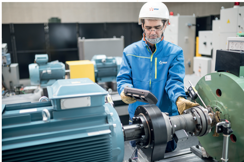
Essais et mesures sur banc alternateur
