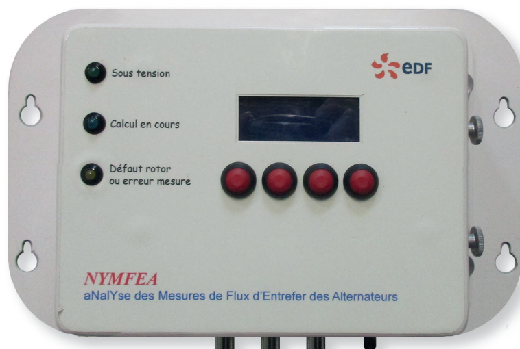
Le boîtier NYMFEEA pour le diagnostic rotor
