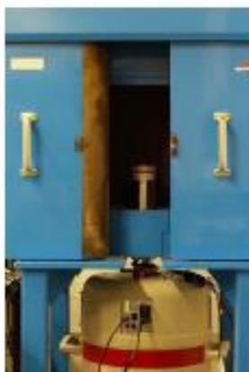
Photo 5. Chaîne de spectrométrie gamma
