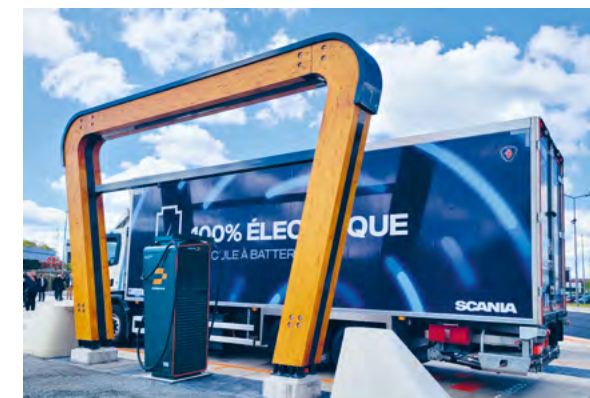
Centre de recharge pour poids lourds électriques à Heudebouville (27). En 45 minutes, un camion peut disposer d'environ 500 kilomètres d'autonomie.
